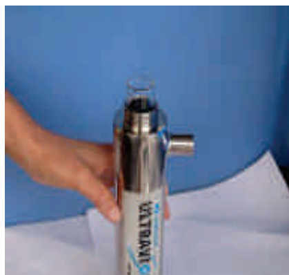
1. Przymocuj komorę UV pionowo, a następnie włóż tuleję kwarcową
